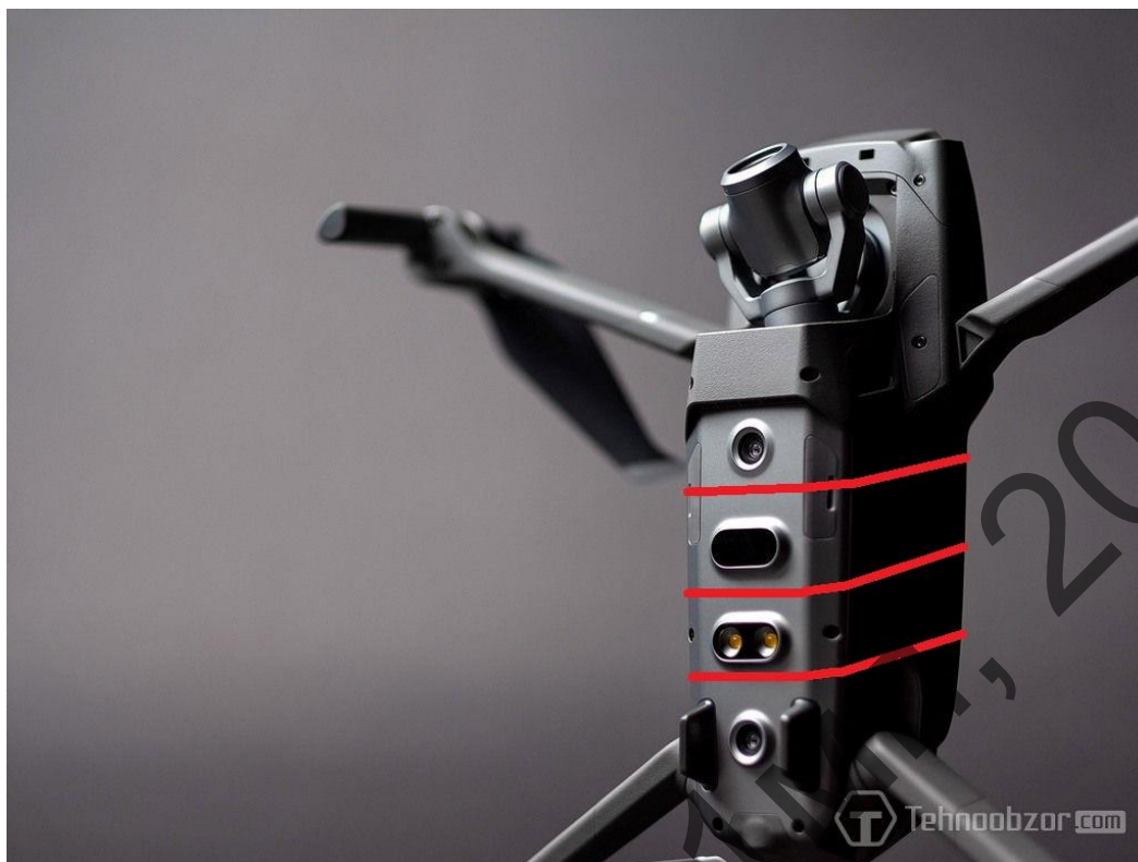
Рисунок 3.10 – схема розміщення стяжок для закріплення пристрою на поверхні БПЛА Dji mavic
