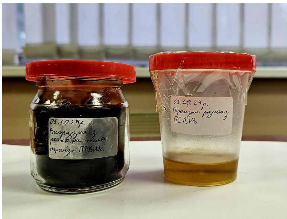
Рис. 3.15 - Кінцеві продукти реакції піролізу ПЕВЩ без використання каталізатора, зліва направо: пірокарбон, піролізна рідина.
