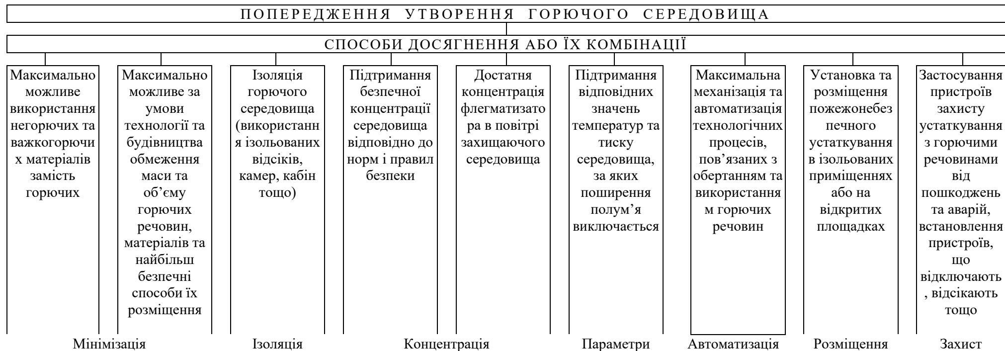
Рис. 12.3 . Схема забезпечення попередження утворення горючого середовища
