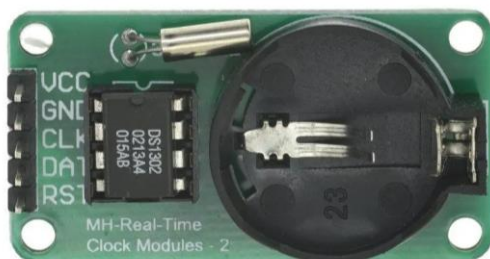
Рисунок 2.4. – RTC Модуль DS1302 [19]
