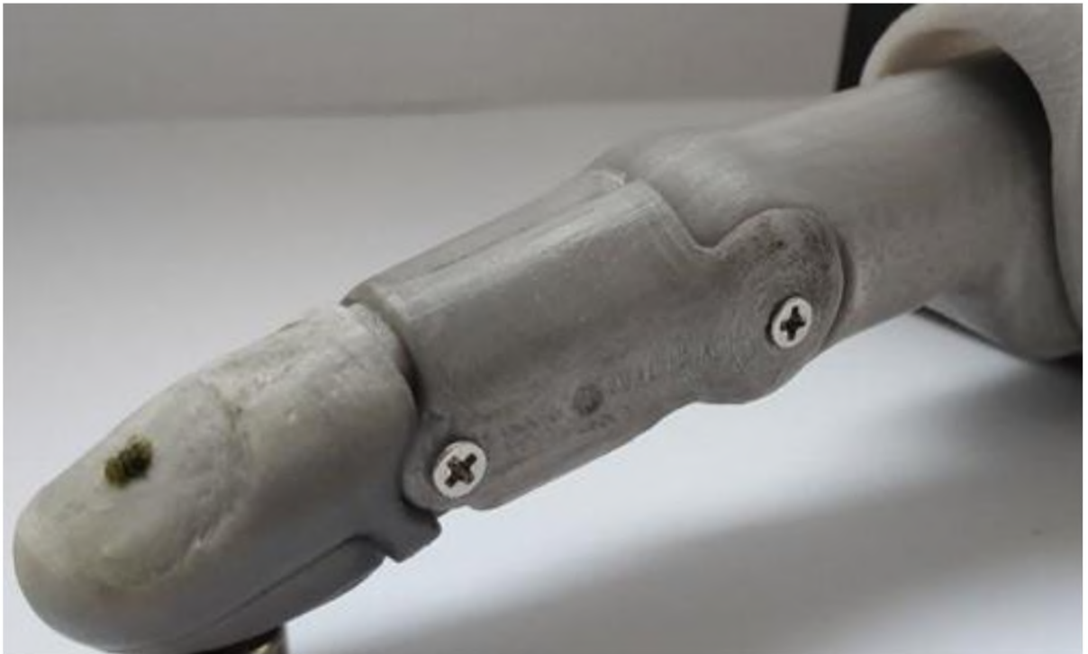
Рис. 3.2. Конструкція штучного пальця для розміщення модулю оптичного зворотного зв'язку
