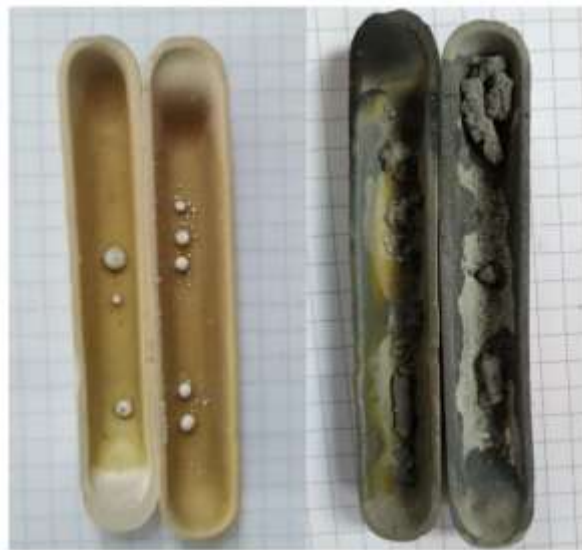
Рисунок 3.3 – Станум, що утворився в ході CVD-процесу при порушенні температурного режиму
