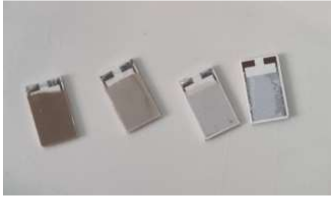
Рисунок 3.9 – Підкладки з чутливими шарами на основі нанокристалічного \text{SnO}_2
