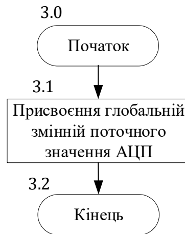
Рисунок 13.6 – Схема алгоритму обробки переривання завершення перетворення АЦП
