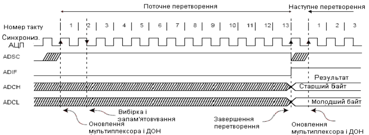
Рисунок 14.7 – Часові діаграми роботи АЦП у режимі одиночного перетворення
