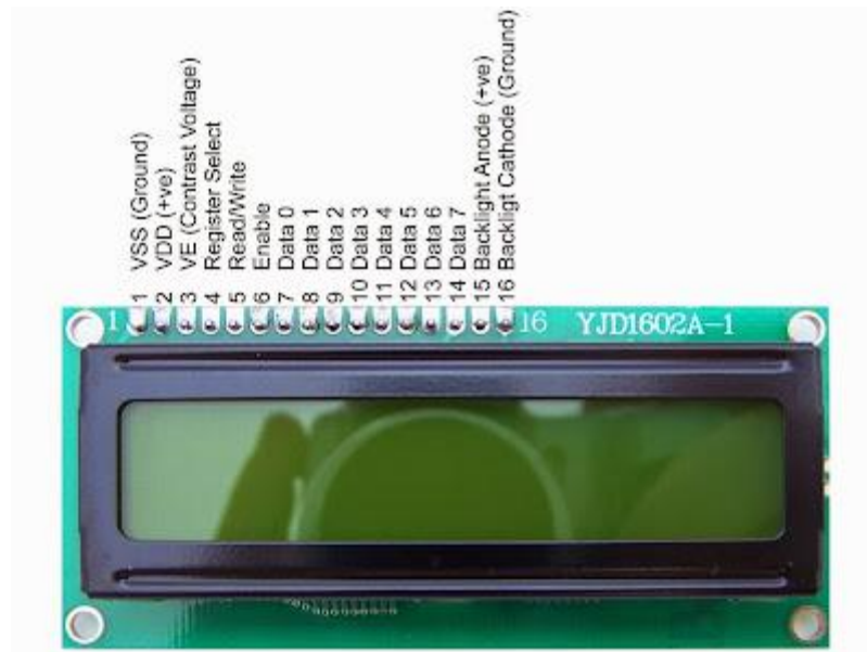
Рисунок 13.1 – Зовнішній вигляд індикатора типу HD44780
