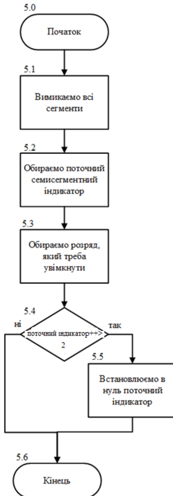
Рисунок 14.15 – Схема алгоритму обробки переривання від таймера 2
