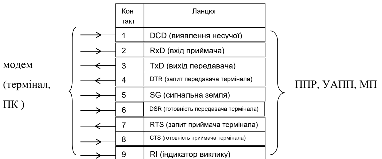
Рисунок 15.17 – 9-контактний роз'єм RS-232C
