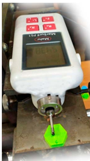
Рисунок 4.2 – Процес вимірювання шорсткості поверхні 3D-виробу
