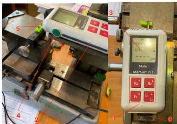
Рисунок 4.3 – Загальний вигляд профілометра MarSurf PS1 для вимірювання шорсткості поверхні 3D-виробу
