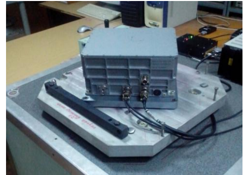
Рис. 10. Статичні випробування БІНС на розв'язаному фундаменті
