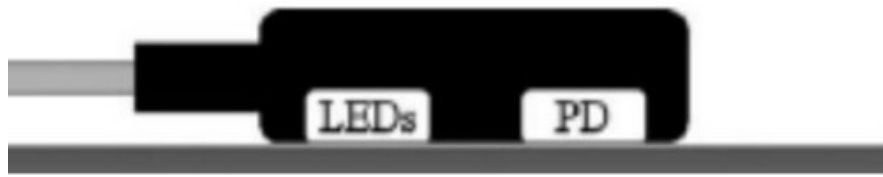
Рис 1.2 – Принцип роботи рефракційного пульсоксиметра.
