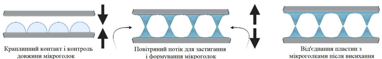
Рисунок 6.2 – Схема процесу виготовлення мікроголок методом крапельного продування повітрям [16]
