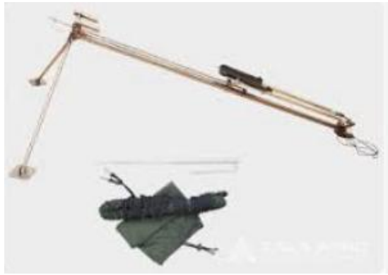
Рисунок 1.7 – Гідравлічна катапульта для БПЛА[22]
