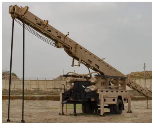
Рисунок 1.8 - Пневматична катапульта для БПЛА[2]
