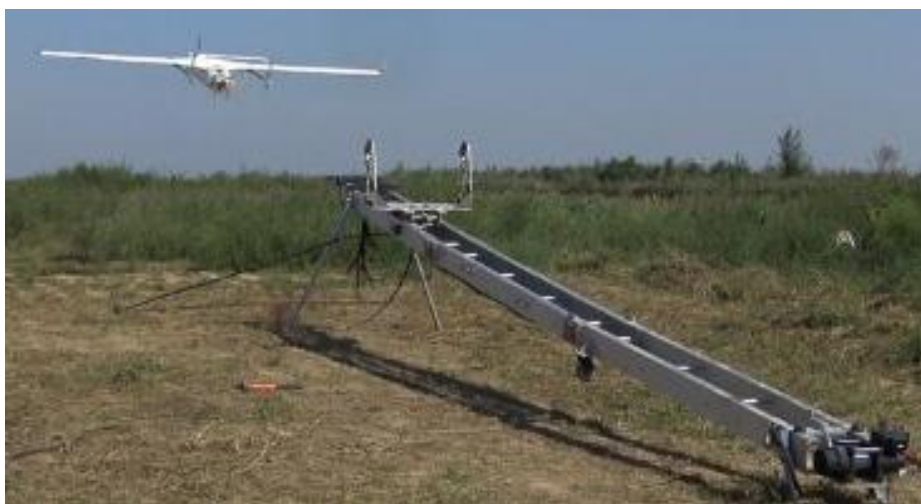
Рисунок 1.2 Приклад гумових катапульти для БПЛА[17-18]
