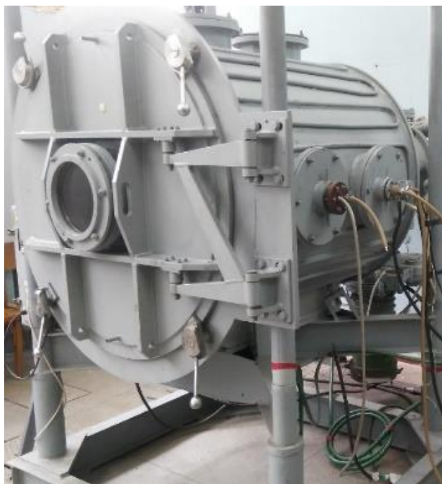
Рисунок 2.2 – Робоча камера установки ВБУ-КП після модернізації
