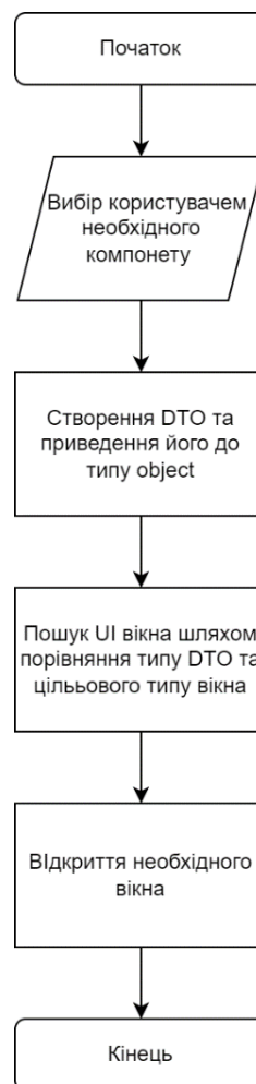
Рисунок 3.11 – Блок-схема роботи алгоритму виведення параметрів тестового компоненту
