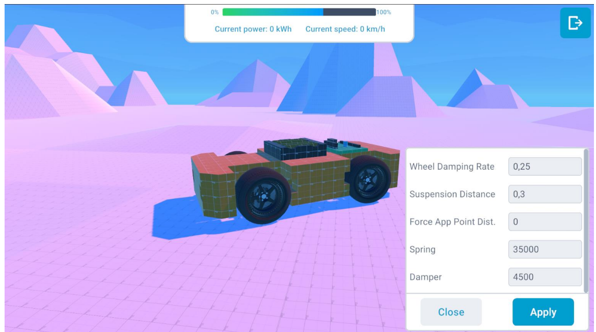
Рисунок 4.8 – Вікно налаштувань тестових параметрів компоненту на сцені тестування
