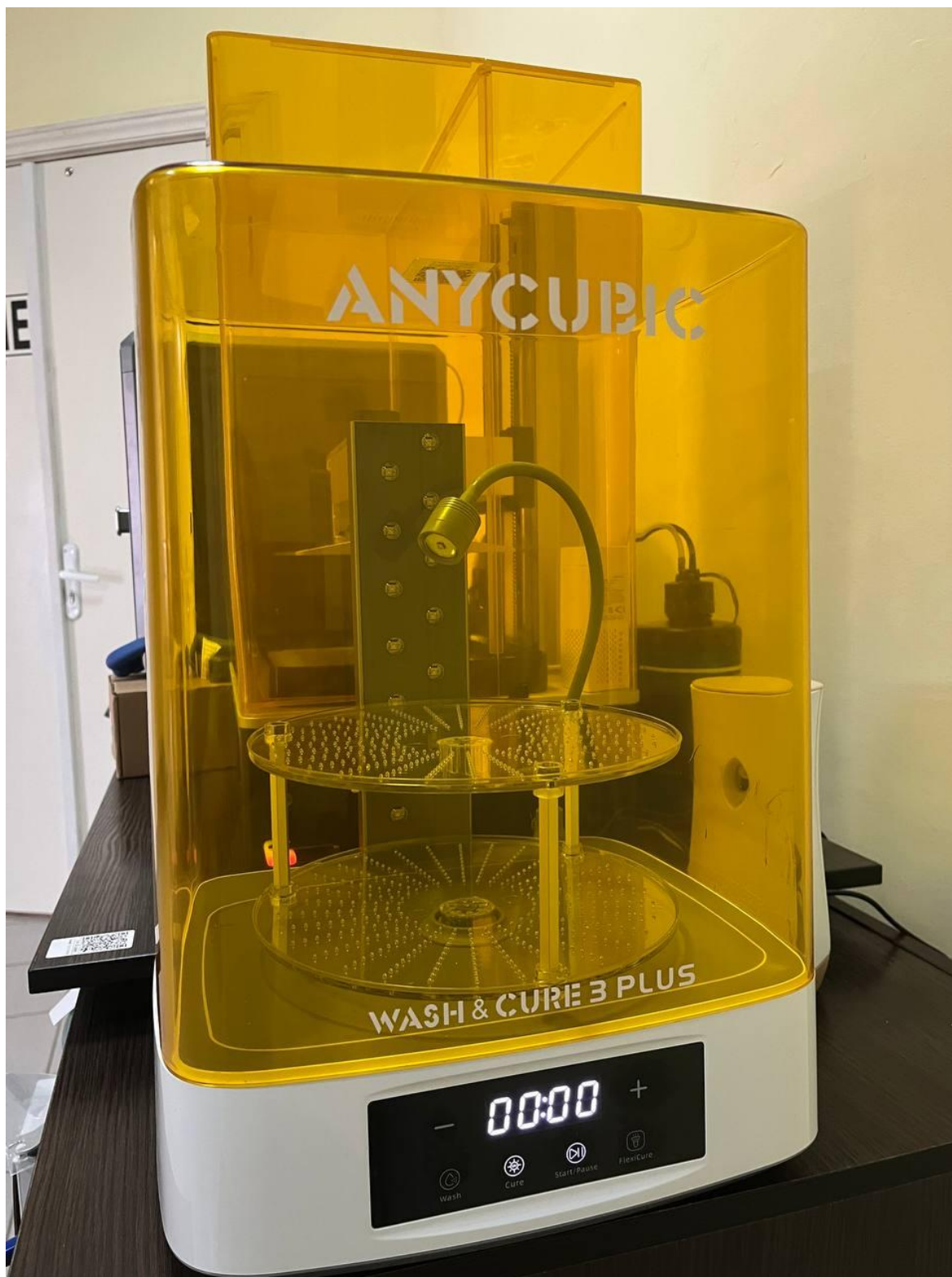
Рис.2.16 - Anycubic Wash and Cure 3 Plus налаштований для полімеризації
