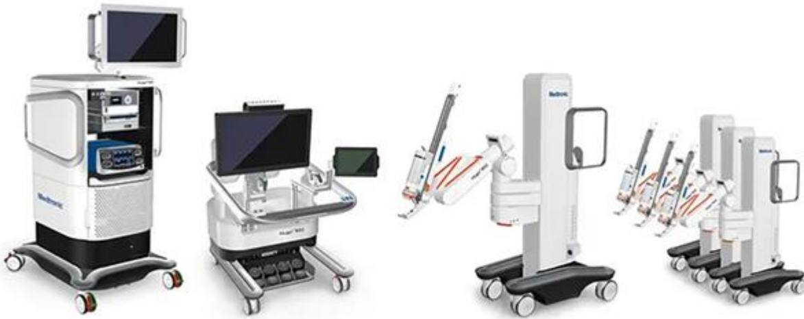
Рис. 2.3. Повний комплекс роботизованої хірургічної системи Hugo RAS (Medtronic) [17]
