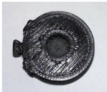
Рисунок 7.3 – Надрукована накладка серводвигуна для кріплення МОНОНИТКИ
