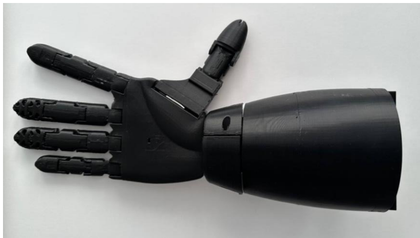
Рисунок 7.2 – Надруковані деталі протезу у складеному виді
