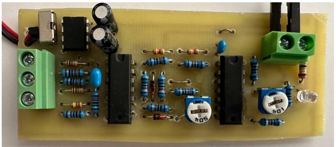
Рисунок 4.11 – Розроблена плата електроміографічного сенсора
