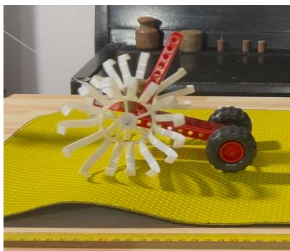
Рисунок 2.7 аркуш 2 - Варіант макетного зразка колісного рушія з пружними елементами типу напівресора на різних поверхнях
