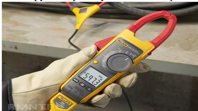
Рис. 1.5 – Конструкція струмових кліщів з цифровою індикацією
