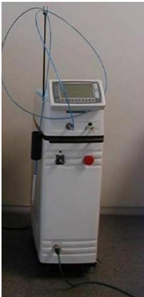
Рис.15 - Фотографія КТР-Nd:YAG лазера, на якому виконуються операції на венах.
