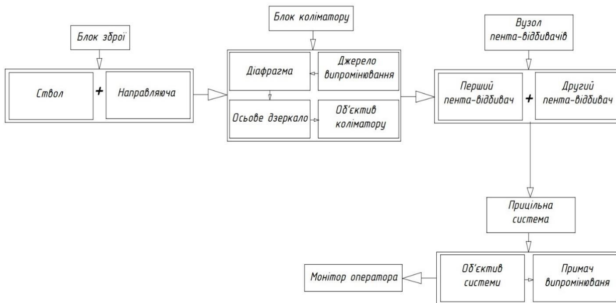
Рис. 2.2. Структурна схема оптико-механічної частини системи "холодного" пристрілювання
