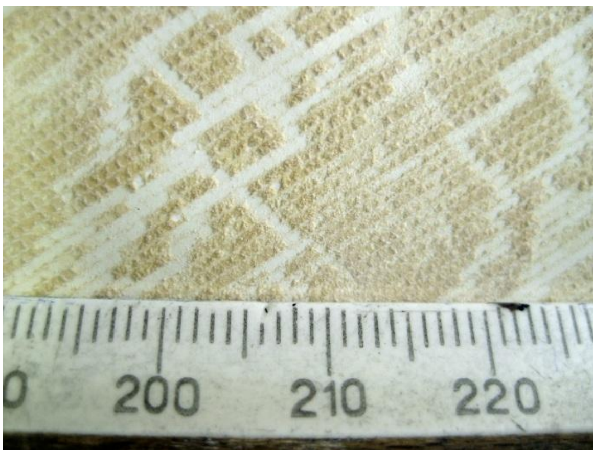
Рисунок 2.3 – Шар забруднень на поверхні мембрани TFC-75
