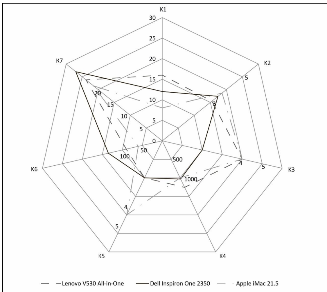
Рисунок 3.5 - Радіальна діаграма для порівняльного вибору раціональної конфігурації графічної станції: K1– оперативна пам'ять, Гб; K2 – тактова частота, ГГц; K3 – кількість ядер, шт; K4 – об'єм пам'яті, Гб; K5 – відеопам'ять, Гб; K6 – потужність БЖ, Вт; K7 – діагональ, дюйм
