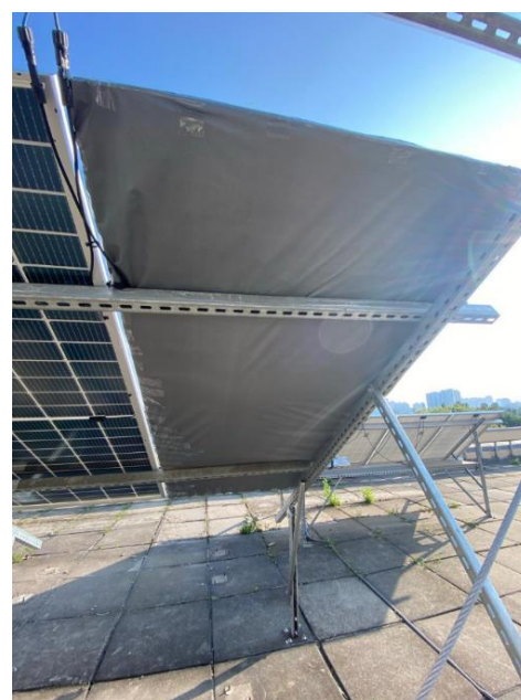
Рисунок 3.1 — Перший стрінг закритий ззаду картоном
