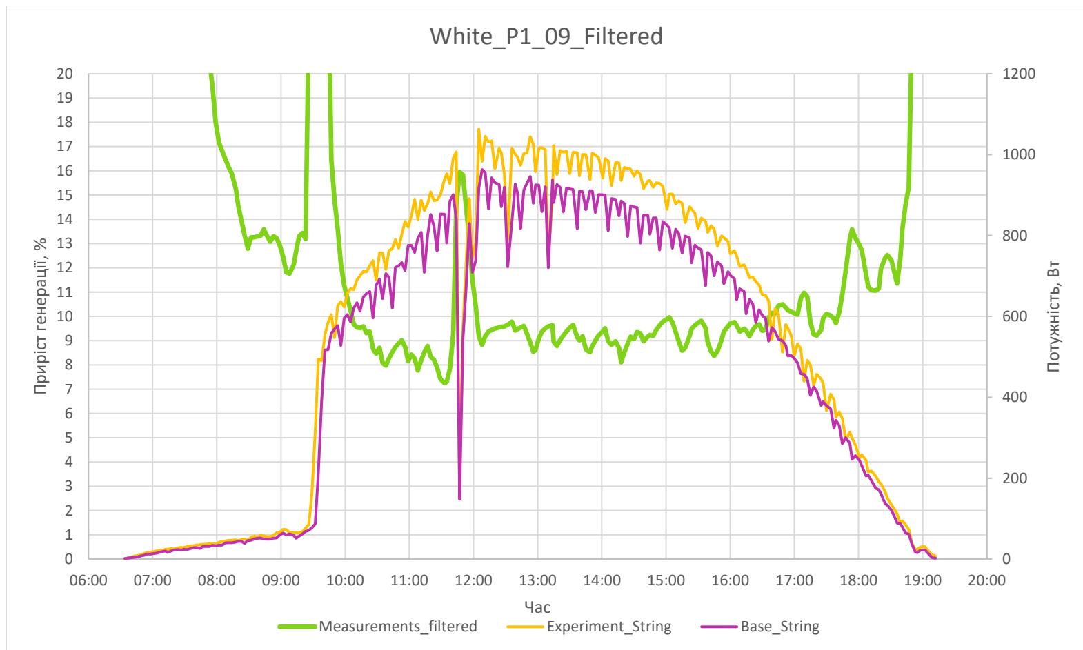
Рисунок Е.7 — Відфільтрований графік генерації за 9-те вересня; форматована вісь. Погода: сонячно, місцями хмарно. Відбиваюча поверхня: світловідбиваюча біла тканина.
