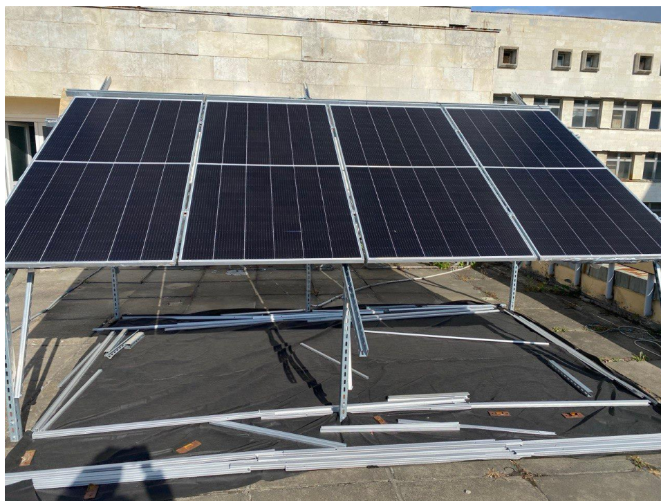
Рисунок 3.6 — Чорне агроволокно в якості відбиваючої поверхні
