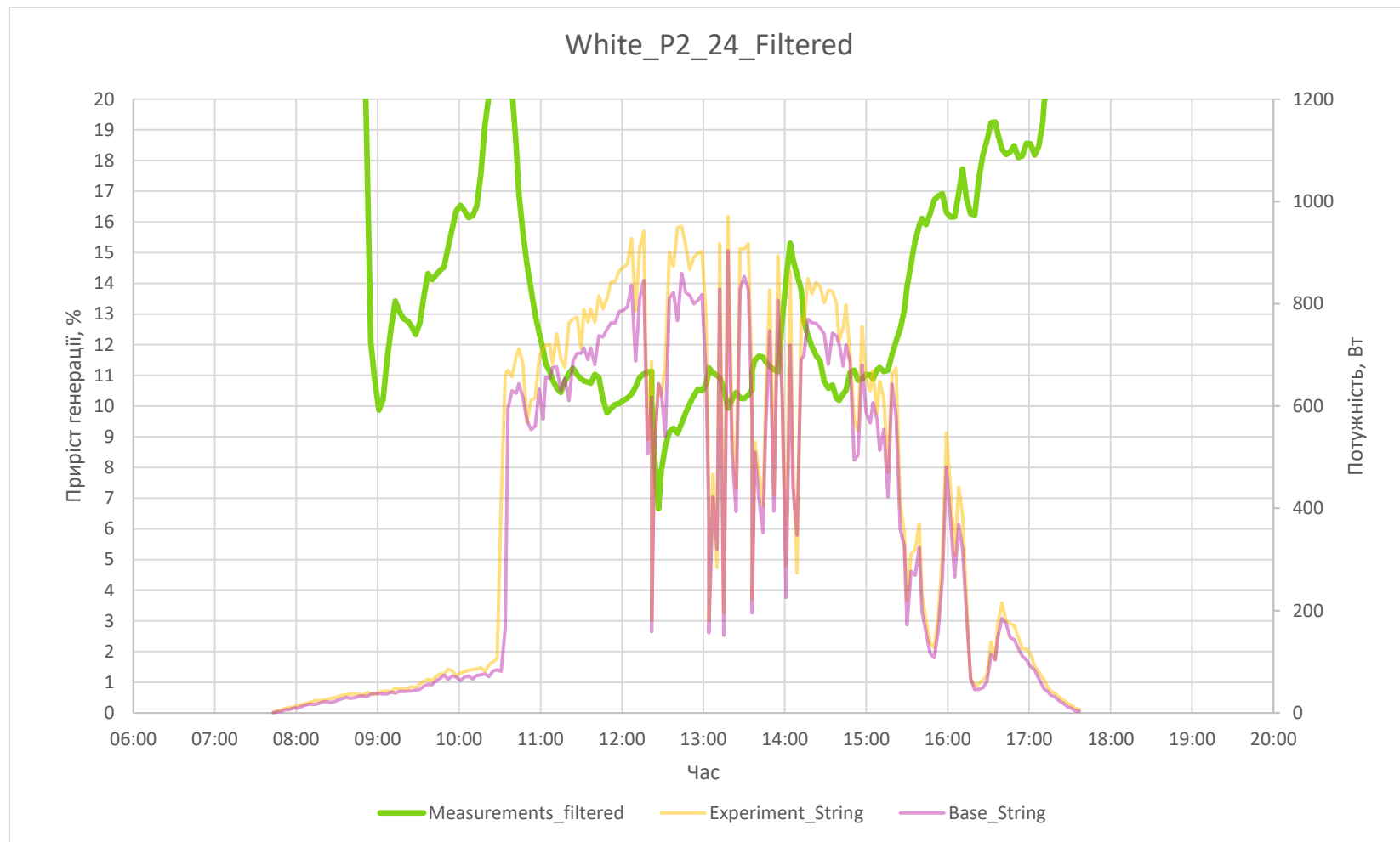
Рисунок Е.23 — Відфільтрований графік генерації за 24-те жовтня; форматована вісь. Погода: сонячно, місцями хмарно. Відбиваюча поверхня: світловідбиваюча біла тканина.
