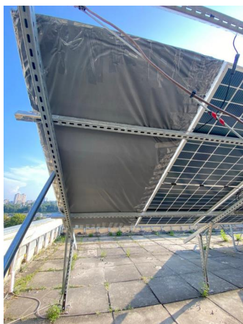
Рисунок 3.1 — Перший стрінг закритий ззаду картоном
