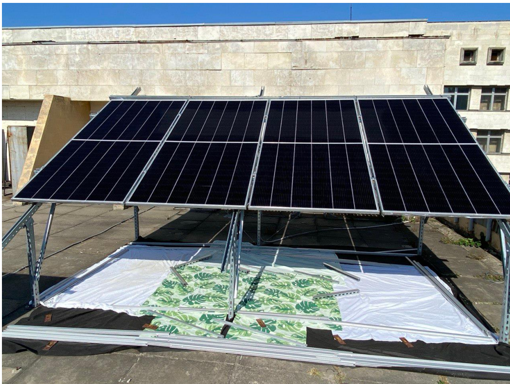
Рисунок 3.5 — Біло-зелена тканина в якості відбиваючої поверхні
