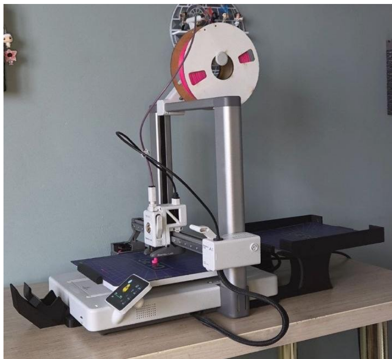
Рис. 4.3 – Фотографія розгорнутого діючого прототипу системи автоматизації 3D-друку
