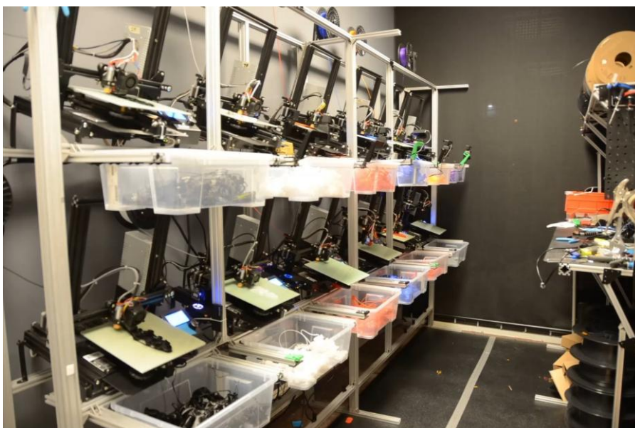
Рис. 1.5 – Ферма автоматизована шляхом скидання виробів екструдером
