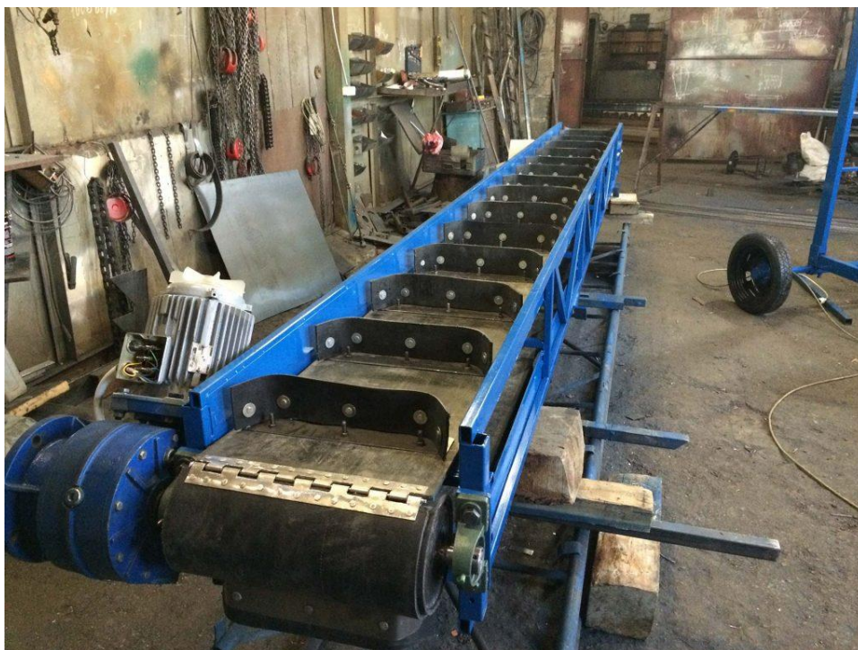
Рисунок 1.1 – Приклад скребкового конвеєра
