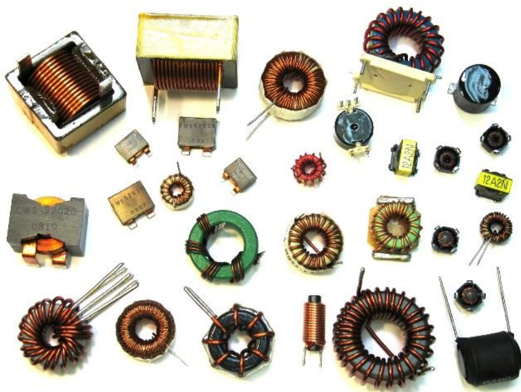
Рисунок 1.2 – Варіанти конструкцій котушок індуктивності [5]
