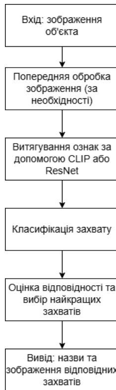
Рисунок 2.1 - Функціональна схема підсистеми
