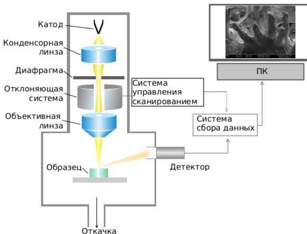
Рис. 2.4. Схема скануючого електронного мікроскопу [16]
