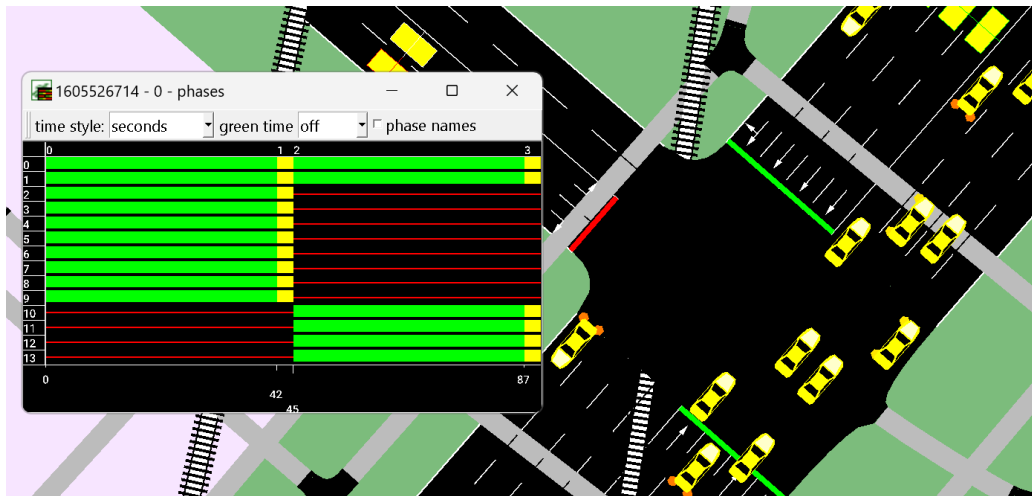
Рис.3.7 Фази роботи світлофора
