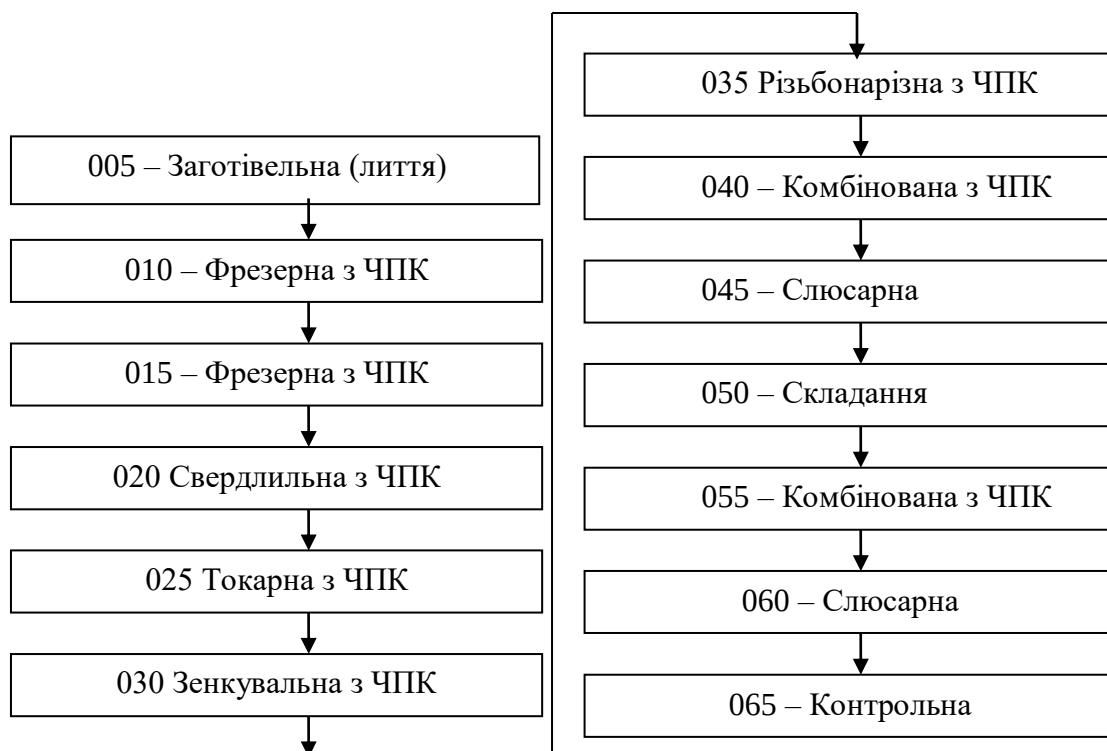
Рисунок 2 Технологічний процес виготовлення деталі кришка
