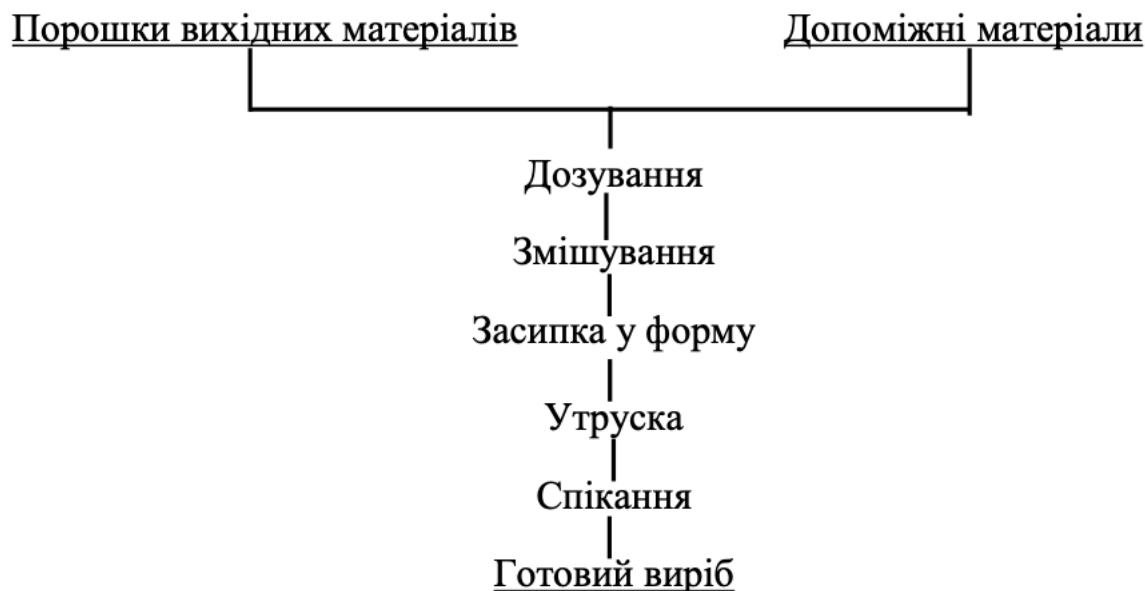
Рисунок 1.5 – Технологічна схема виготовлення високопористих виробів методом спікання вільно насипаного порошку
