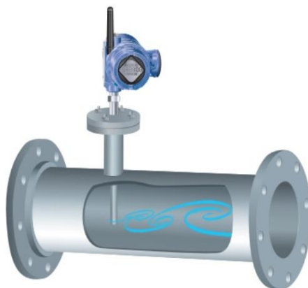
Рисунок 2.17 – Монтаж датчиків температури в трубопроводі
