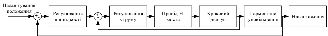
Рисунок 4.2 – Структурна схема системи управління із замкнутим контуром гібридного крокового двигуна
