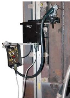
Рисунок 3.2 – Зварювальна каретка-трактор типу Bug-O
