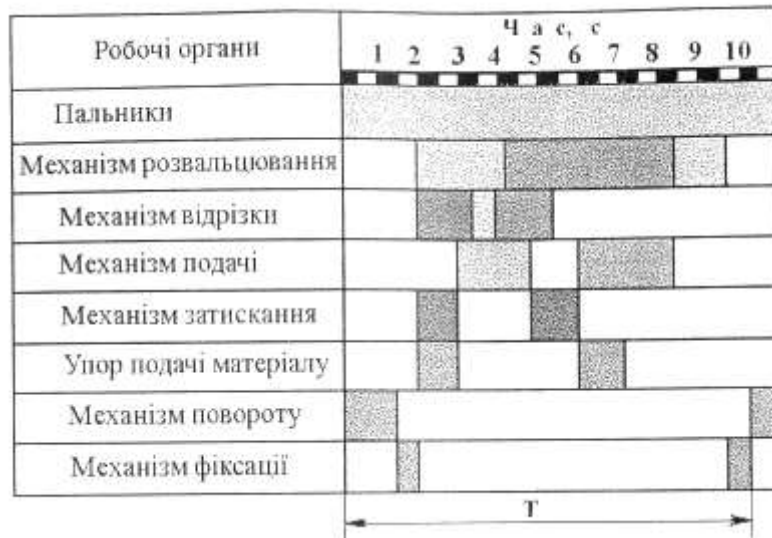
Рис. 1.13. Циклограма роботи автомата виготовлення тарілочки електролампи
