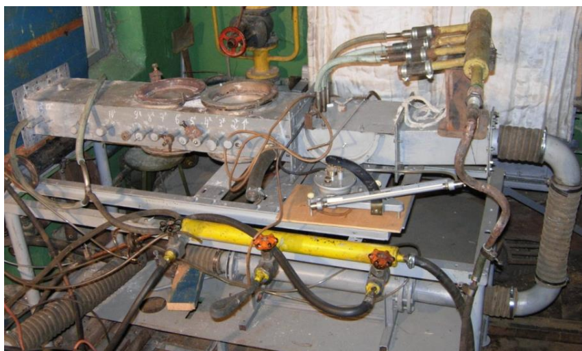
Рисунок 2.4 - Експериментальний стенд для випробувань характеристик стабілізаторів в закритому каналі.
