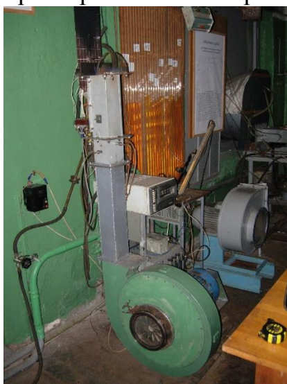
Рисунок 2.2. Стенд для вивчення горіння за стабілізатором у відкритому просторі
