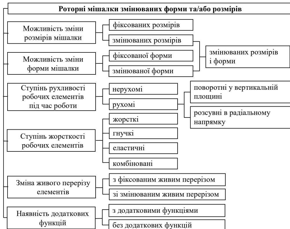
Рис. 3.26. Класифікація роторних мішалок змінної форми та/або розмірів [19]
