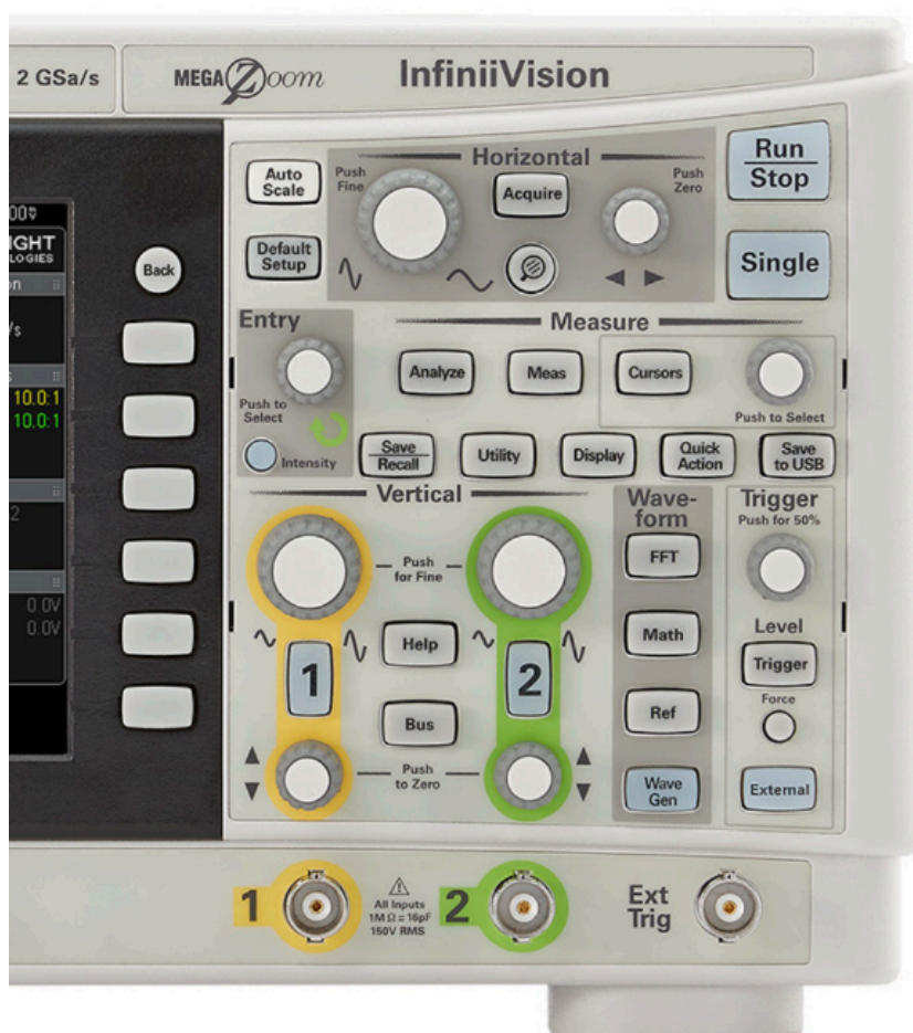
Рис. 2.9. Органи керування та індикації осцилографа DSOX1102G [6]
