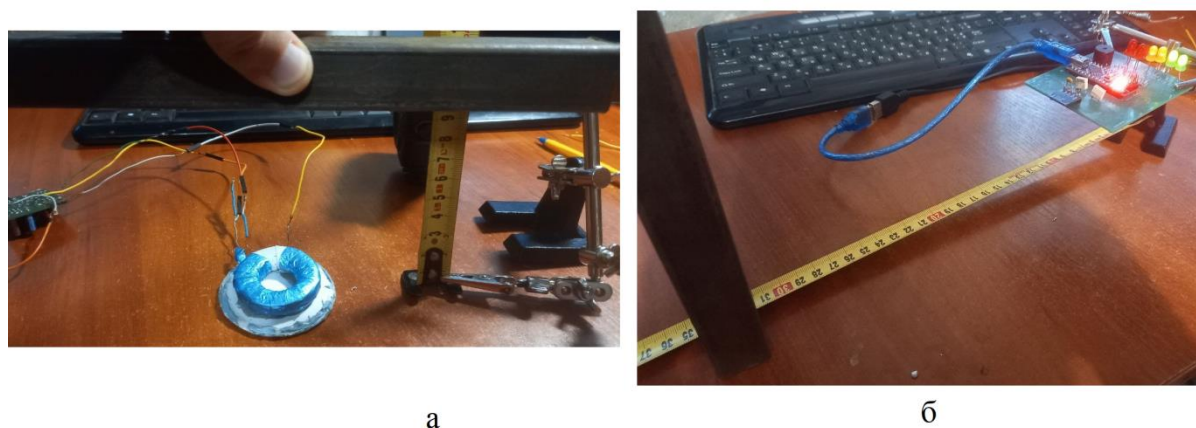
Рисунок 6.2 — Порівняння відстані реакція WFO (а) та магнітометричного металодетектора (б) на феромагнітного об'єкта
