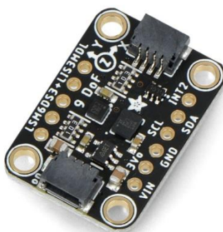
Рисунок 7.1— Магнітометр LIS3MDL як приклад високочутливого сенсора
