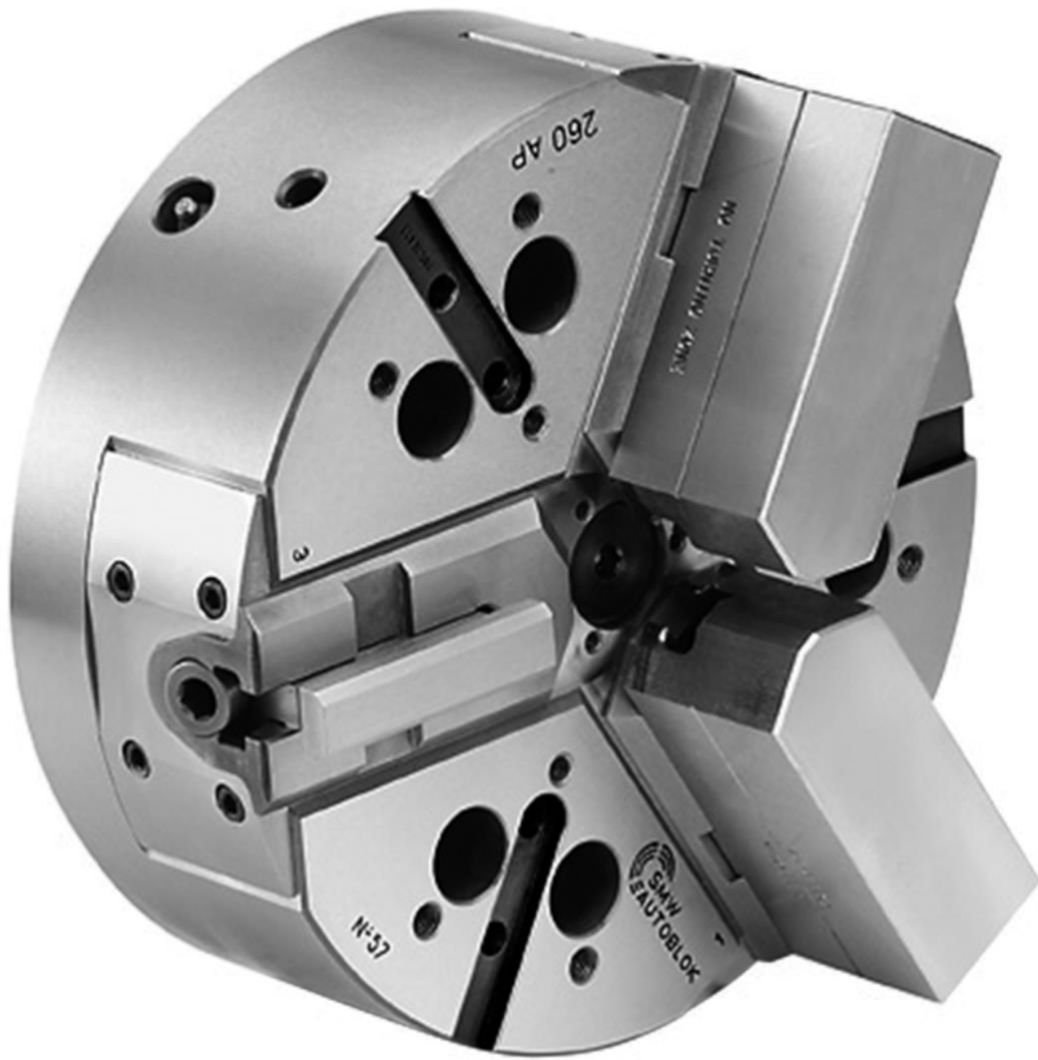
Рисунок 2.3 – Конструкція модуля швидкої зміни кулачків/вкладишів токарного патрона
