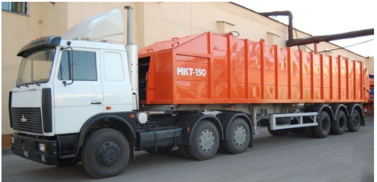
Рис 2.4 - смітєвоз МКТ-150 з тягачем МАЗ-64229
