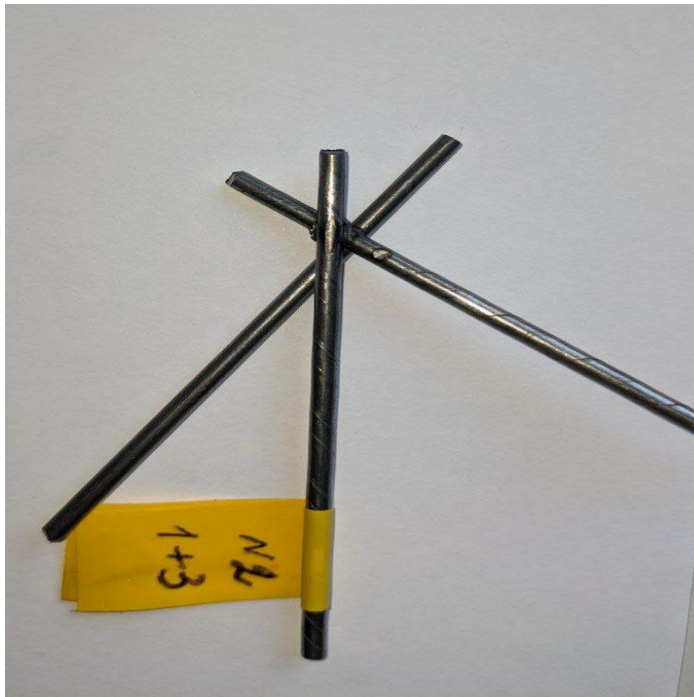
Рис. 4.7. Зварювання трьох дротів з часом зварювання 1+3
