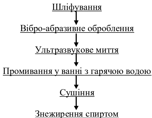
Рисунок 4.2 – Схема підготовки поверхні за технологією вакуумно-конденсаційного напилювання
