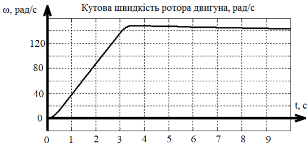
Рисунок 4.8 – Кутова швидкість ротора двигуна
