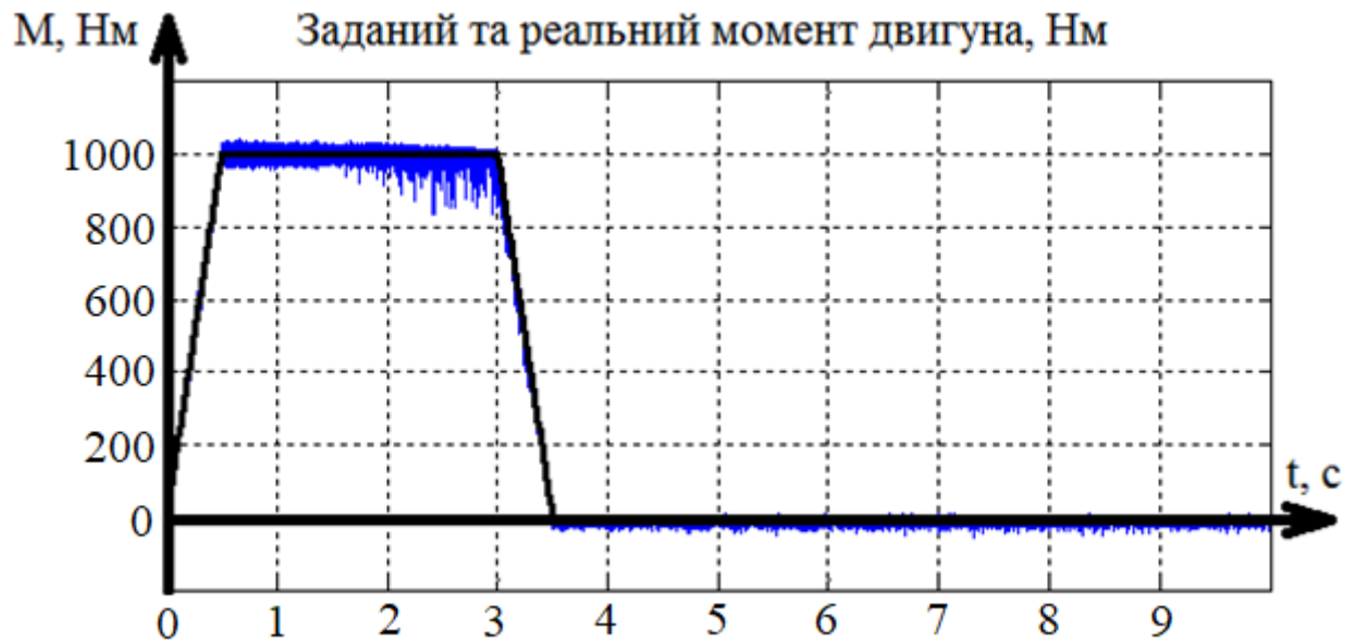
Рисунок 4.7 – Реальний та заданий момент двигуна
