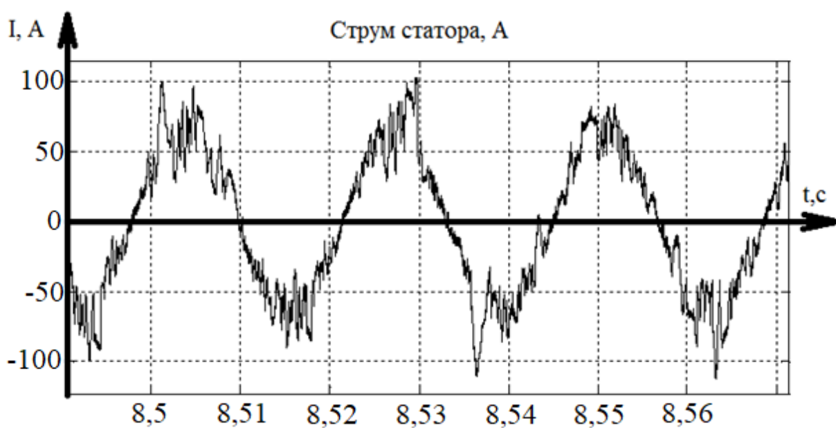
Рисунок 4.5 – Струм статора при роботі на статичній швидкості
