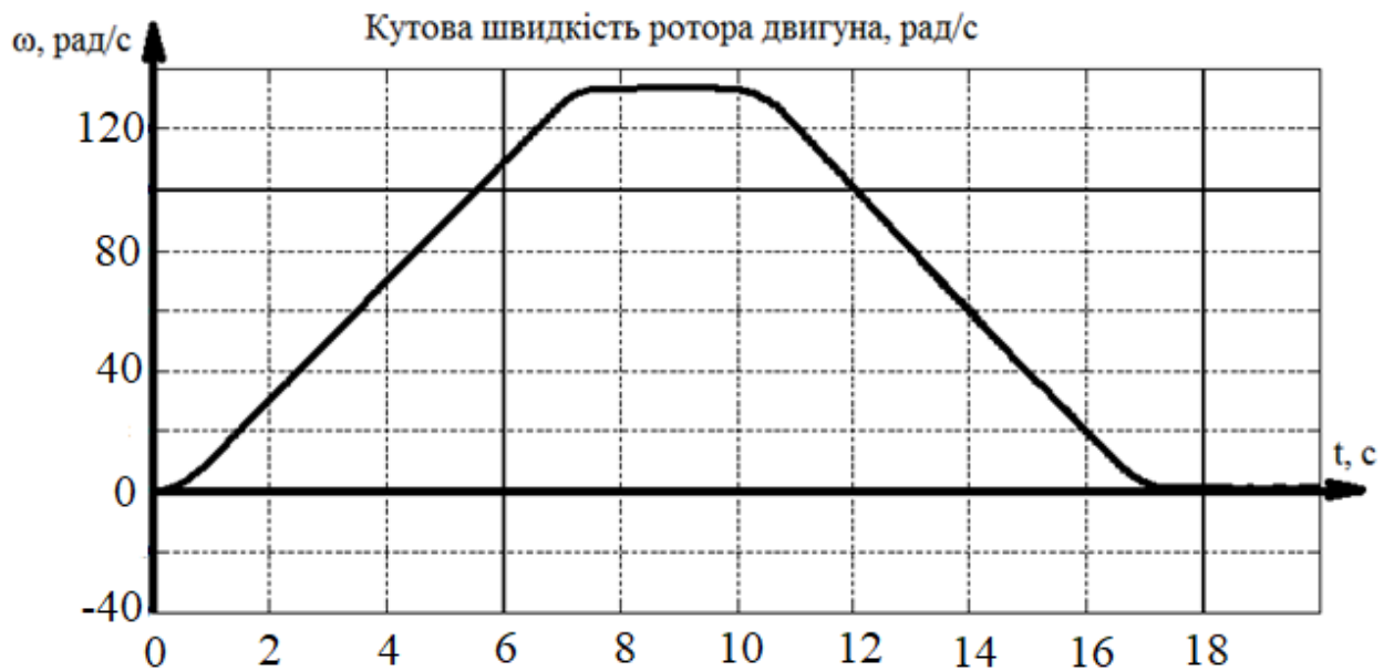
Рисунок 4.3 – Залежність кутової швидкості обертання ротора двигуна від часу
