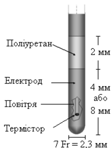
Рисунок 4.3 – Схематичне зображення електрофізіологічного катетеру та активного електроду для РЧА
