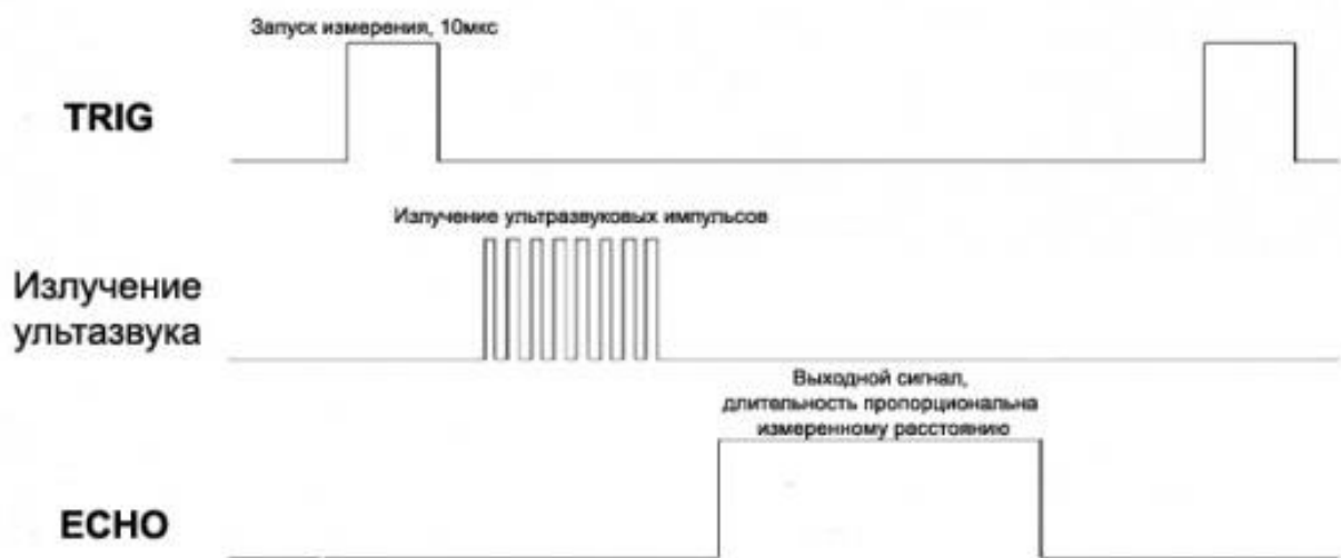
Рисунок 5.4. Діаграма роботи дальноміру HC-SR04
