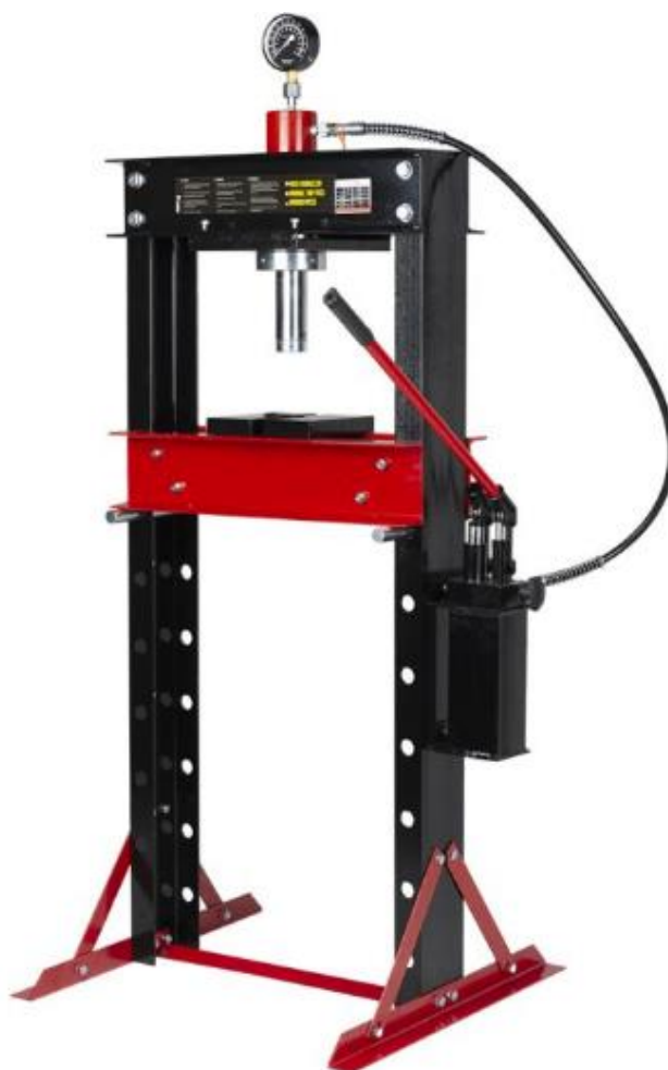
Рис.1.2 Пресс гідравлічний з подвійним насосом 30 т REDATS H-380 [1]
