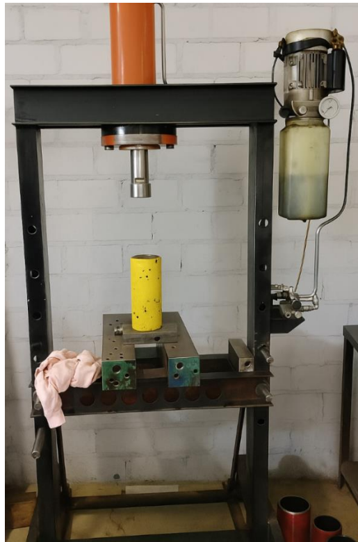
Рис.1.1 Гідравлічний прес для розпресування вузлів
