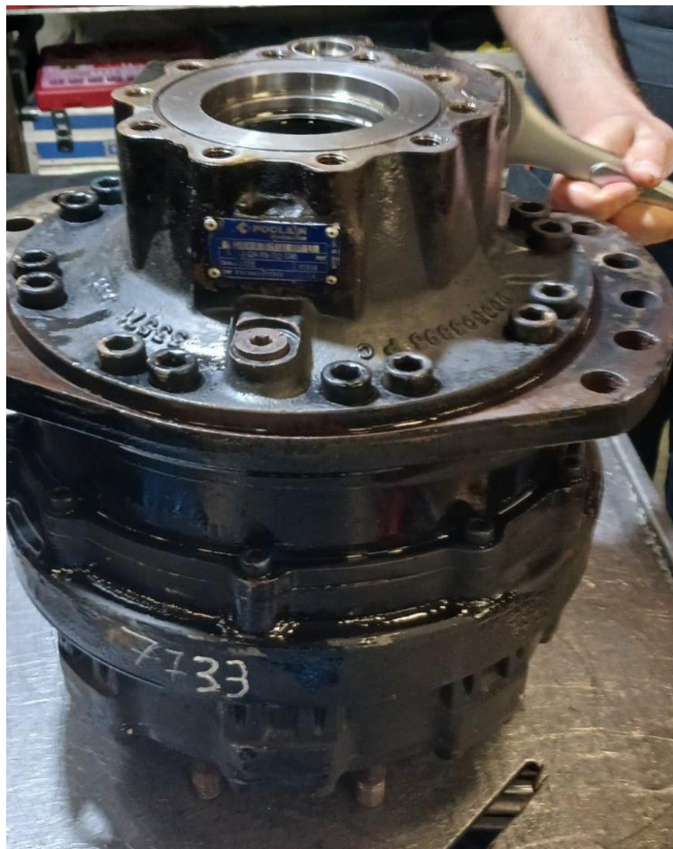
Рис.3. Гідромотор серії MS18
