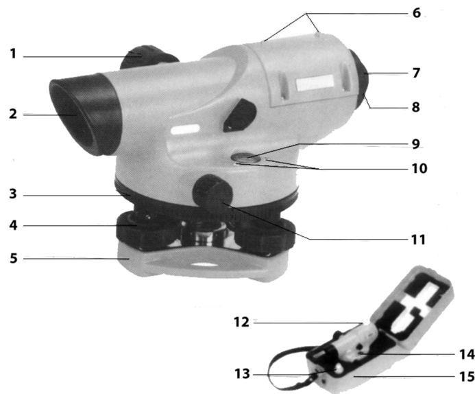
Рис. 4.1. Оптичний нівелір South NL-20: 1 – фокусуючий гвинт, 2 – зорова труба, 3 – горизонтальний лімб, 4 – підйомні гвинти, 5 – підставка, 6 – візир, 7- окуляр, 8 – протипилове кільце, 9 – круглий рівень, 10 – юстировочні гвинти, 11 – горизонтальний навідний гвинт, 12 – юстировочні шпильки, 13 – нівелір, 14 – кейс для переноски.
