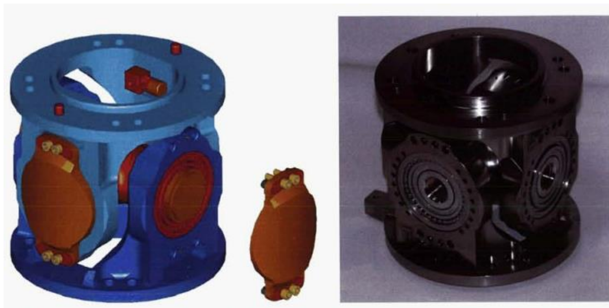
Рис. 2.6. - Вузол качання СКВТ двигуна VINCI другої ступені майбутньої РН Ariane
