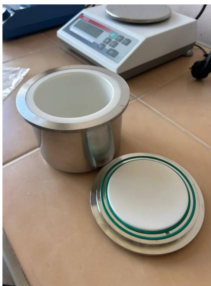
Рисунок 2.2 – Стакан для розмелювання у планетарному млині
