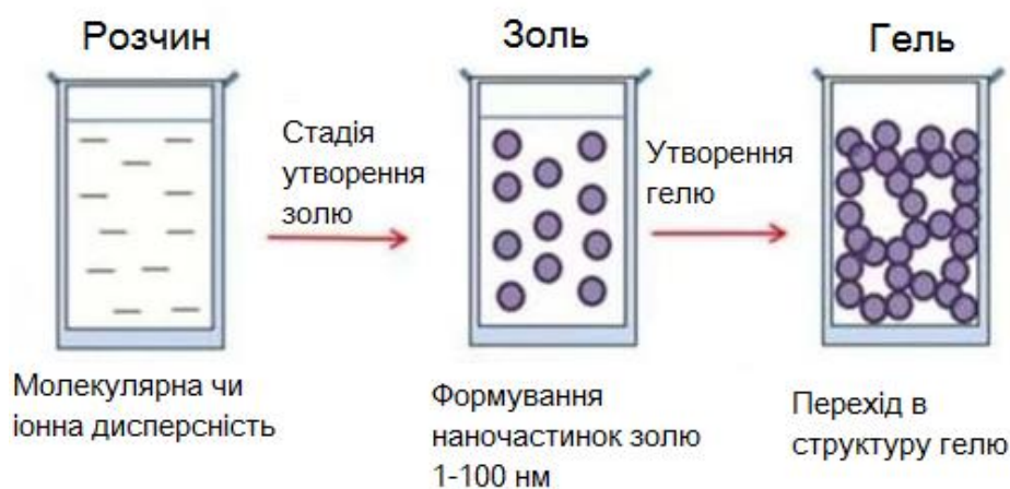
Рисунок 1.7 – Схема золь-гель методу
