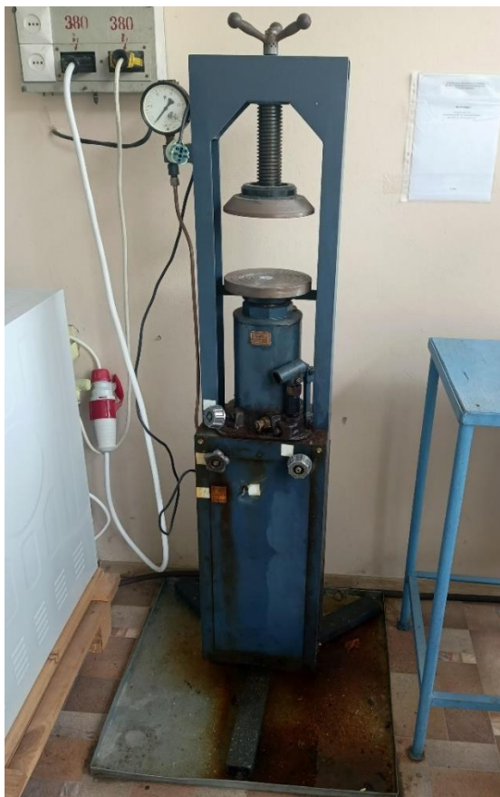
Рисунок 2.5 – Зовнішній вигляд гідравлічного пресу
