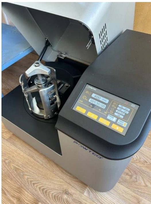
Рисунок 2.1 – Зовнішній вигляд планетарного млина Powteq BM6Pro
