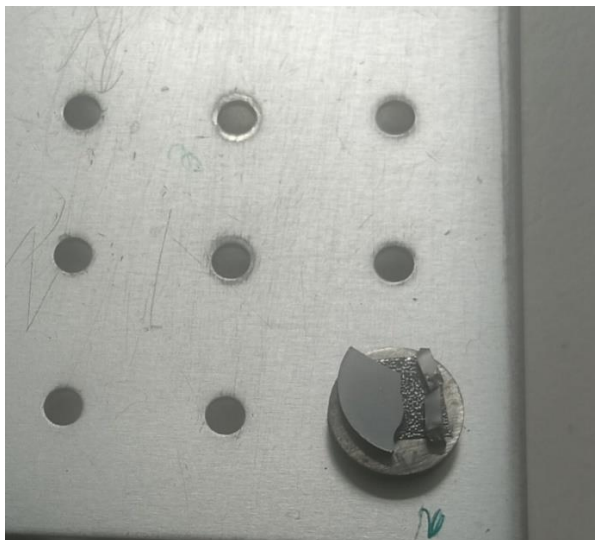
Рисунок 2.10 – Вигляд зразку електроліту з нанесеним покриттям 30 нм складу \text{Au}_{50}\text{Pd}_{50}
